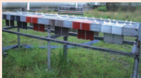
屋根・壁シミュレートパネルの曝露状況
