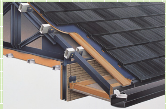
屋根断面「鋼製母屋」
