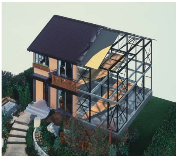
大型屋根パネル
