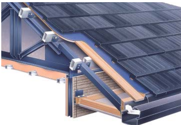
屋根断面「鋼製母屋」
